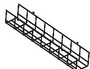
Canalización en barras de metal galvanizado, diámetro 3 mm, soldado, fijado con placas y tornillos debajo de la tapa de la mesa.
