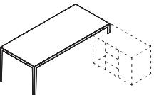
Каркас стола, приставных и переговорных столов составлен из опорных ног, перекладин по периметру, которые сделаны из гнутого стального листа толщиной 2 мм, покрытого порошковым лаком на эпоксидной основе следующих отделок Anodic Black (AB) Oxide 2 (OX) Quarz 2 (QU), оснащается регулируемыми ножками круглой формы из АБС пластика со стальным резьбовым стержнем.
