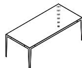
Estructura para escritorios, alas auxiliares y mesas de reunión, constituida por patas y vigas perimetrales realizadas en chapa de acero doblada de 2 mm de espesor. Barnizada en polvo epoxi, color Anodic Black (AB) Oxide 2 (OX) Quarz 2 (QU), equipado con niveladores con base circular de ABS y perno de regulación de acero roscado.
